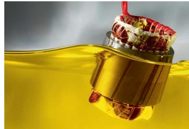
Abb. 4: Darstellung des Imprägnierungsprozesses.
