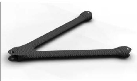
Abb 1: Modell eines Querlenkers
