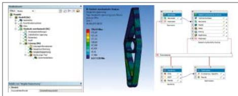
Ausgangssituation vor der Optimierung und Simulationsaufbau in Ansys Workbench
