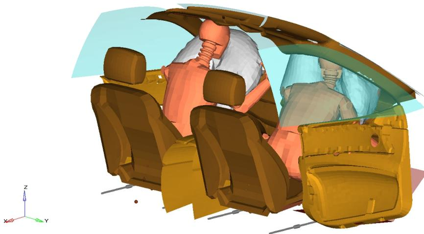
Abbildung 2: Simulation Insassenschutz Lastfall FMVSS 208
