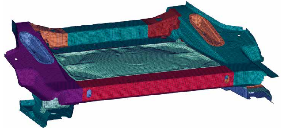
Bild 2: Die Simulation führt zu einem optimierten Sickenmuster mit einem gut interpretierbaren Verlauf (unten).
