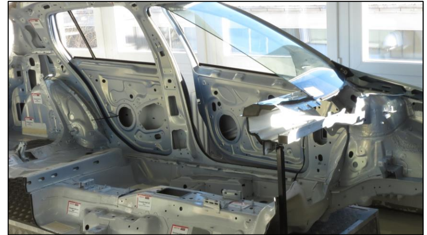
Karosserie mit geklebten ABC-Säulen und Frontscheibe
