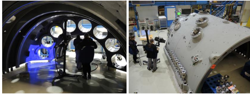
Bild 1: Messung der realen Geometrie mittels Laserscans
