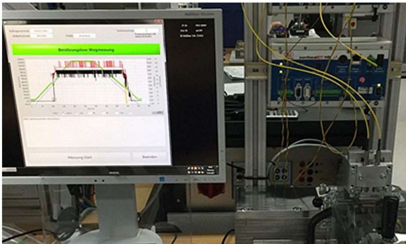
Abbildung 6: Messung mechanischer Kennwerte unter Laborbedingungen am offenen Relais
