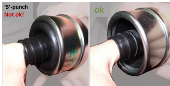
Abbildung 2: "S-Schlag"-förmige Verformung (links) und ideales Abrollverhalten (rechts) des Rollbalgs
